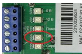
Рисунок 19 – Светодиод VD3 «Обновление»
