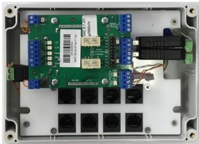
Рисунок 12 – Вариант установки системного блока Контроллера со смещением. Подключение преобразователей USB RS 485 SV к системному блоку Контроллера внутри корпуса
