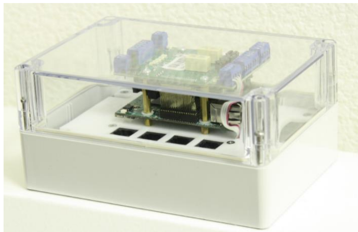
Рисунок 1 – Внешний вид контроллера SV 720 с модулем расширения в пластиковом корпусе
