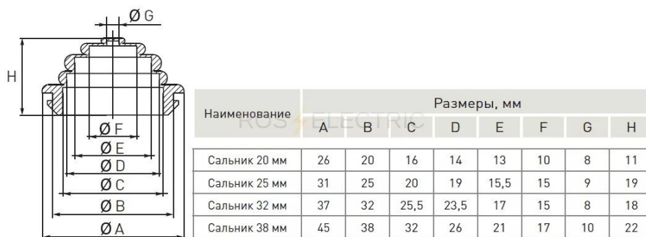
Рисунок 11 – Зависимость диаметра установочного отверстия от размера ступенчатого кабельного ввода (сальника)
