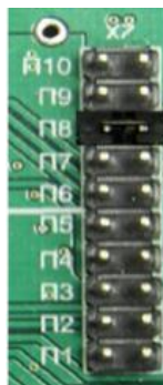
Рисунок 45 – Установленная перемычка П8
