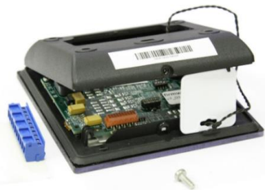
Рисунок 22 – Демонтаж задней панели считывателя
