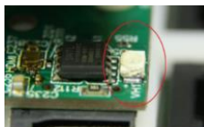
Рисунок 16 – Светодиод индикации наличия внутрисистемного питания 5В на нижней системной плате над гнездом флэш-карты
