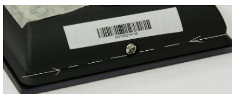
Рисунок 21 – Стык корпуса устройства и задней панели (серые стрелки)
