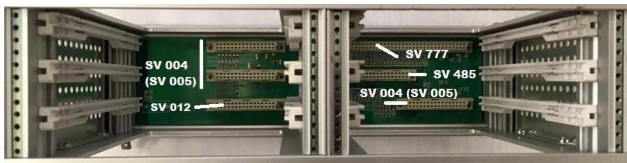
Рисунок 11 – Шасси (корзины) SV B03 с указанием разъемов и порядка установки плат
