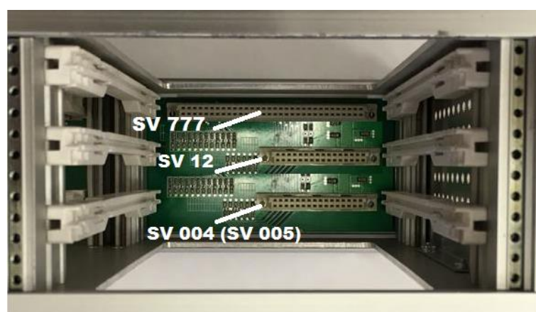
Рисунок 10 – Шасси (корзины) SV B02 с указанием разъемов и порядка установки плат
