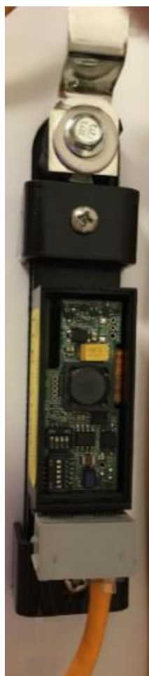
Рисунок 3 – Тыльная сторона замка-считывателя SV HANDLE со снятой крышкой, подключенный к разъему X 1.1 по интерфейсу RS 485 SV
